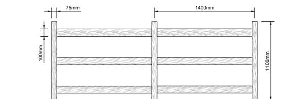
TYPICAL TIMBER POST & RAIL FENCE DETAIL
